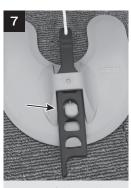
高強度ロープが張りすぎている 場合は、衝撃吸収ベルトの穴位置 をずらし調整してください。
