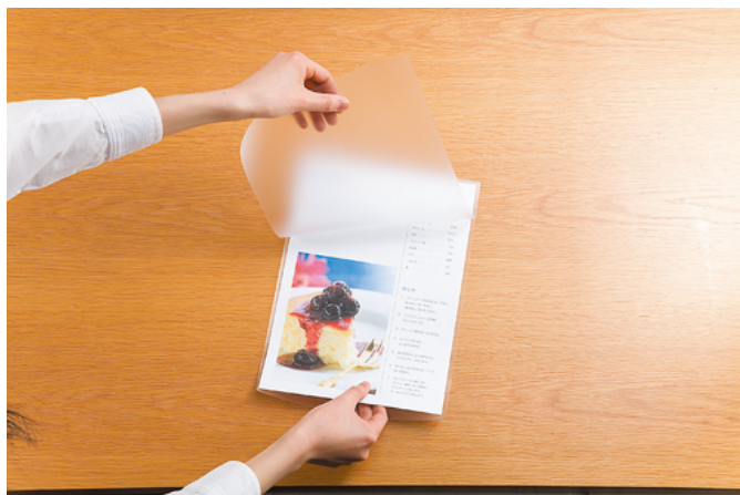
(2) フィルムを開き、フィルムの先端に合わせてパウチする用紙を挟む。
