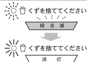
約10秒間くずをならした後、「くずを捨ててください」ランプが点灯し、グラデーションランプが消灯します。(処理方法は6ページ参照)
